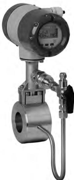
L'OPTISWIRL 4070 est disponible en option avec un robinet d'isolement pour pouvoir remplacer le capteur de pression sans interruption du process.
