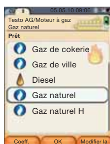
2. Sélection du combustible
