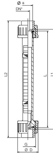
**Dimensions (avec raccord spécial en laiton ou acier inox) taraudage ou filetage**
