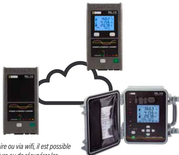
*En filaire ou via wifi, il est possible de suivre ou de récupérer les données connectées de plusieurs PEL sur le même réseau.*
